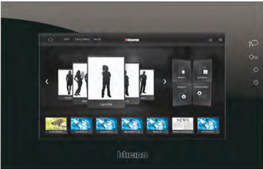
ÉCRAN TACTILE VIDÉO 10" Véritable centrale multifonctions de la maison, cet écran tactile vidéo 10" gère l’ensemble des fonctions MyHOME ® domotique, y compris le vidéo portier, et propose des applications multimédia de type lecteur MP3 ou cadre photo numérique via clé USB et carte SD.
