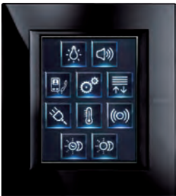
ÉCRAN TACTILE 3,5" Installé dans une zone centrale du logement ou dans les étages, il permet de commander les lumières, les volets, la musique, le chauffage, les scénarios mais également d’activer l’alarme ou encore d’afficher la consommation d’énergie en électricité ou en eau.
